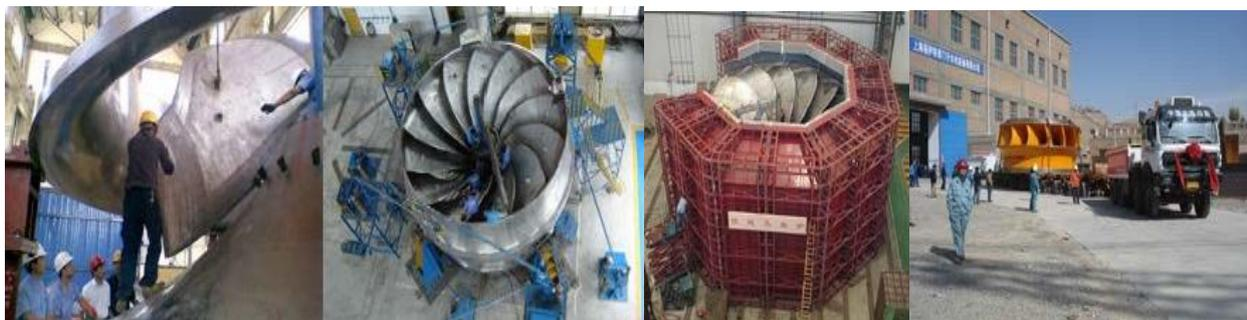
Рис. 1. Изготовление на месте (выверка, сварка, термообработка, доставка)
