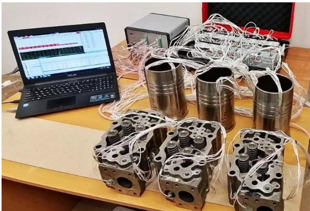
Рис. 1. Тензо-, термометрическое оборудование с исследуемыми объектами
