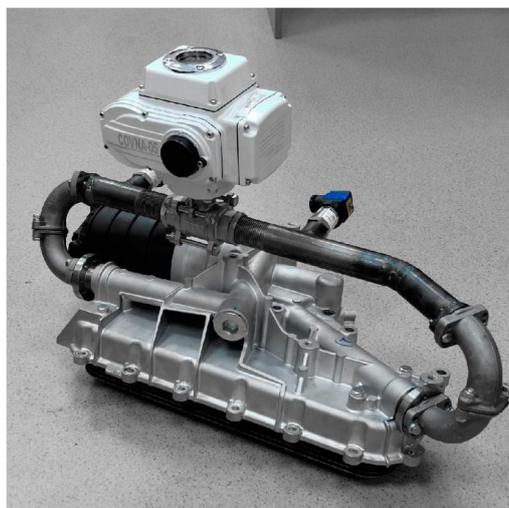
Рис. 2. Опытный образец управляемого термостата системы смазки, установленный на масляный модуль
