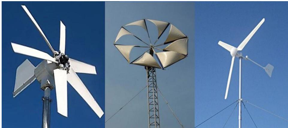
Рис. 1. Классические ВЭУ с горизонтальной осью вращения
