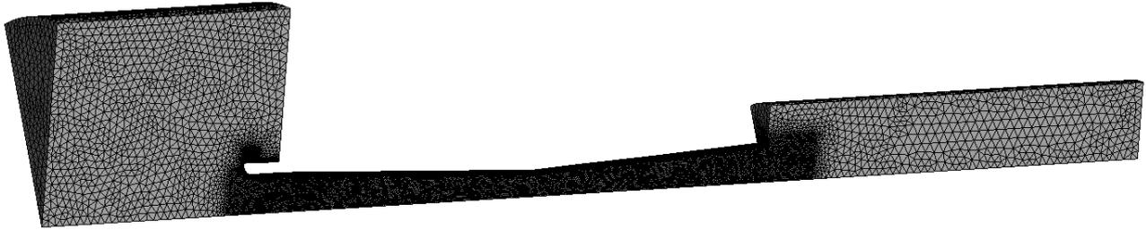
Рис. 5. Общий вид построенной сетки (600 тысяч элементов)
