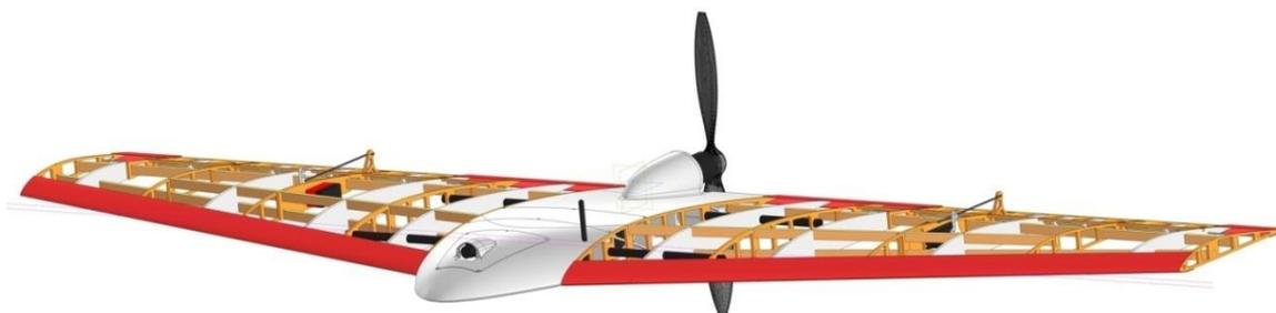
Рис. 5. Модель БПЛА для инженерного чемпионата, созданная в программе «Компас-3D»
