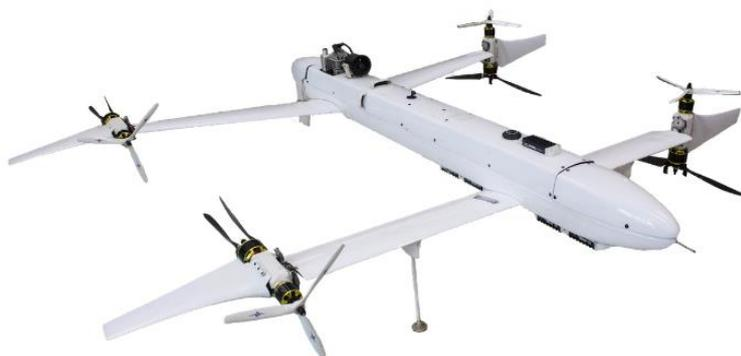
Рис. 6. Конвертоплан с 8ю двигателями способный производить взлет и посадку вертикально
