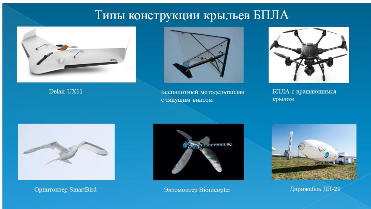
Рис. 1. Типы конструкции крыльев БПЛА
